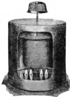
Fig. 4 geeft een werkelijk beeld van de Peridyne-spoel, waarvan een deel der wand is verwijderd.
